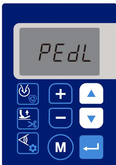
5. Cuando se conecta la corriente eléctrica de la máquina de coser mientras el modo totalmente automático esté seleccionado, se visualiza "PEDL" en el panel de operación como se muestra en la figura de la izquierda. Cuando desee iniciar el cosido, presione una vez la parte delantera del pedal.
