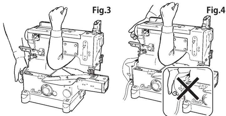
Eliminez auparavant les éventuels traces d'huile sur la machine et sur vos mains pour que la machine ne puisse pas vous échapper des mains.
