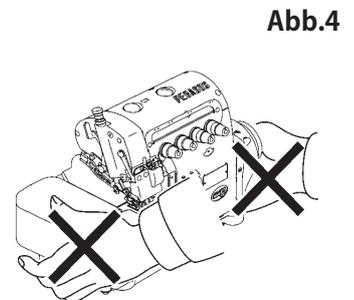
Entfernen Sie vorher mögliche Ölreste an der Maschine bzw. Ihren Händen, damit Ihnen die Maschine nicht aus den Händen gleiten kann.
